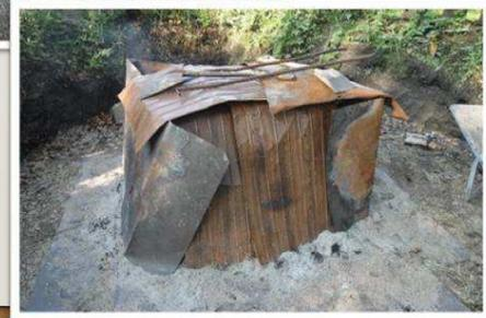
燃焼前半は、草木灰で覆った部分が崩れてしまうので、崩れた部分に草木灰を被せて覆いを補修します。
