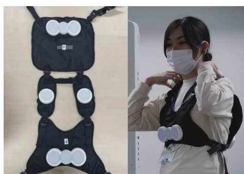
図5 Furekit と、着用した様子。両肩・お腹・背中に白いモジュールが付いており、触ると音が鳴りぶるぶると振動する
